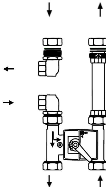
1 1/4" IG zu alternativer Wärmequelle (z.B. Öl- oder Gaskessel)
