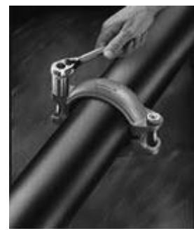
Après le montage, le raccord Victaulic se met en place dans les moulures à l'intérieur du tuyau. Le joint en forme de C réagissant à la pression s'adapte au tuyau à rainure standard roulée ou fraîchement roulée. Tous les raccords compris dans la livraison comportent un joint agréé pour les installations d'eau chaude sanitaire (jusqu'à 110 °C).
