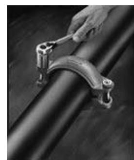
Nach der Montage greift die Victaulic Kupplung in die im Rohr befindlichen Sicken. Die auf Druck reagierende C-förmige Dichtung passt sich dem standardroll- oder fräsgenutetem Rohr an. Alle mitgelieferten Kupplungen enthalten eine für Warmwasseranlagen (bis 110 °C) zugelassene Dichtung.
