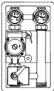
Retour du robinet à boisseau sphérique avec thermomètre bleu et frein à commande par gravité intégré :
